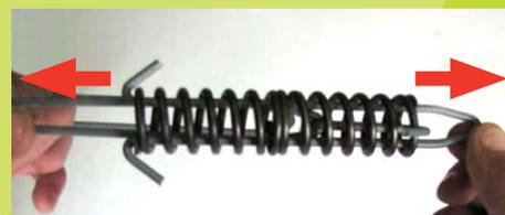
Enfin, tirer sur le grand double crochet pour verrouiller le ressort entre les crochets. Répéter le montage pour la deuxième partie. Votre coulisse peut maintenant être montée sur vos piquets en tête de vigne.
